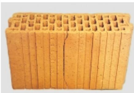
Bild 11 Ziegel mit Trocknungs- oder Brennris
